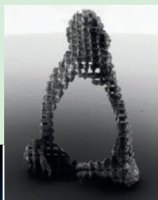
Additiv gefertigter Steigbügel in einem ORMOCER®-Material.
